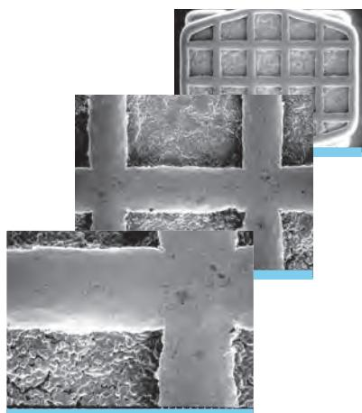
Цельнолитые кнопки, изготовленные по технологии MIM® из биомедицинской стали, не содержащей никеля\*. Анатомическая основа Extremo без никеля с микроудерживающими полостями идеально прилегает к зубу и обеспечивает превосходное сцепление при использовании любых видов адгезивов.
